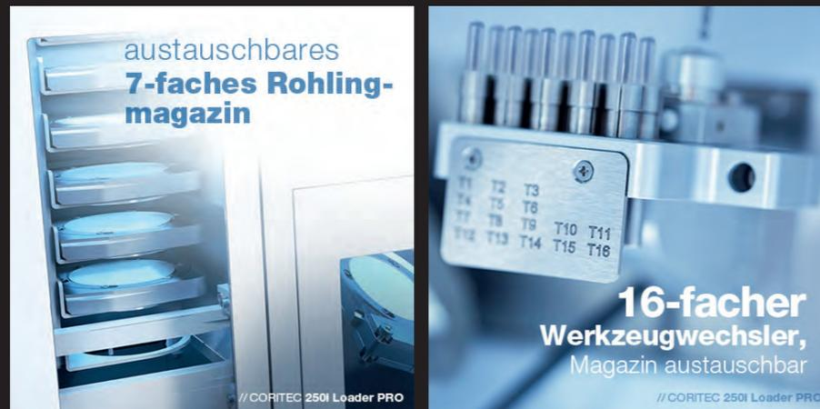
Der vollautomatische 7-fache Rohlingwechsler ermöglicht es, verschiedene Restaurationen ohne Zeitverlust nacheinander zu bearbeiten. Das System bearbeitet jede Restauration mit gleichbleibend hoher Präzision. Dank der modularen Bauweise des Rohlingwechslers ist es möglich, diesen unkompliziert durch ein bereits bestücktes Rohlingmagazin auszutauschen.
