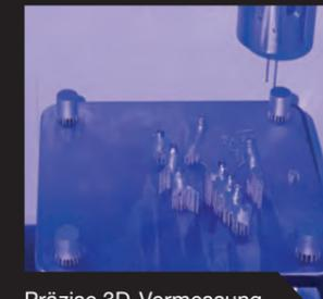
Präzise 3D-Vermessung in der CORiTEC 650i
